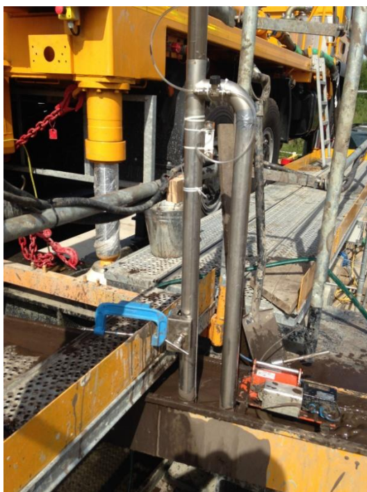
Rys. 10.1. Fotografie otworu poszukiwawczego w Nowej Soli/k Zielonej Góry, z zamontowanym i pracującym opracowanym w ramach projektu desorberem.
