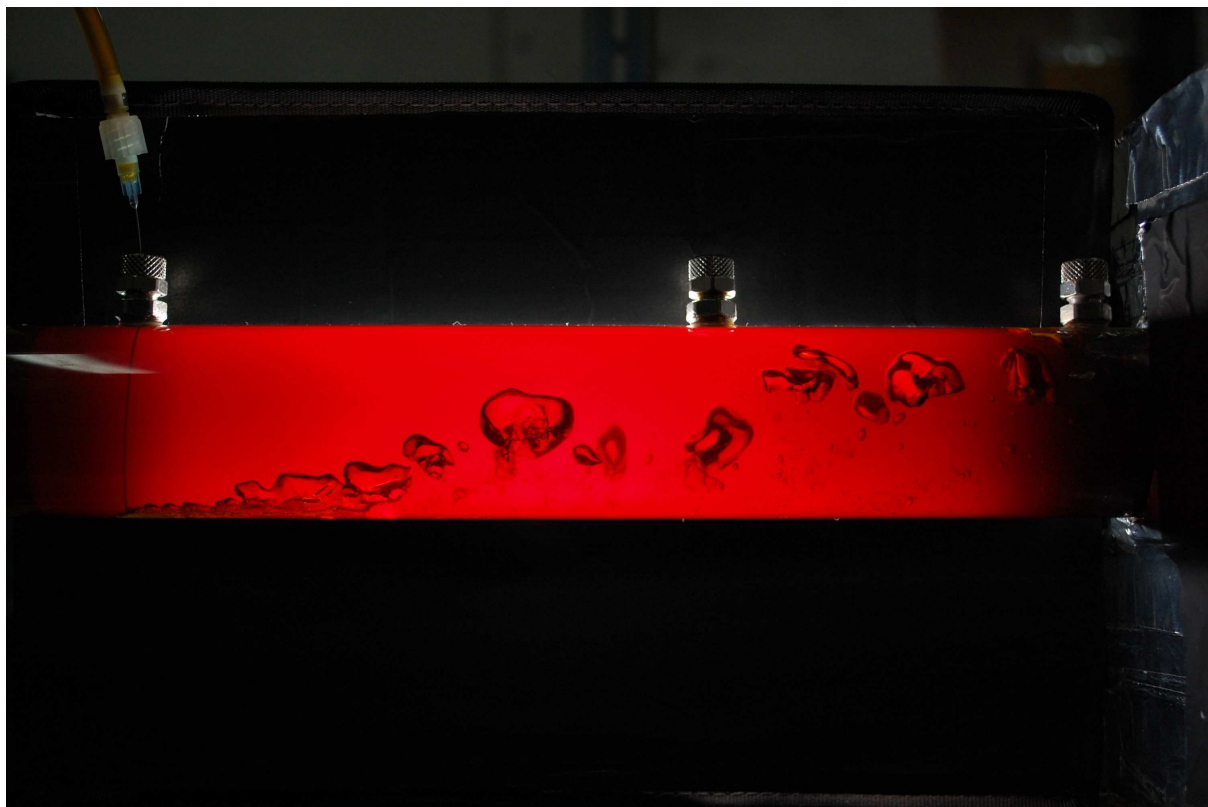
Rys. 10 Zdjęcie 4. Przepływ medium 5,8 m 3 , ilość podawanego powietrza 1 l/min. Pojemność: 2,3889 pF.
