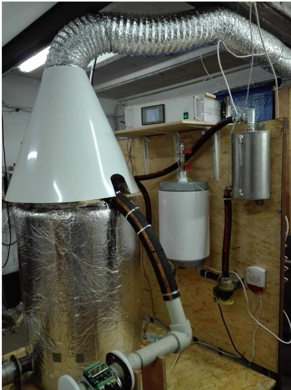
Rys. 4 Zbiornik i podgrzewacz ropy
