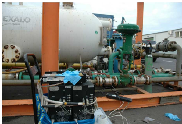
Rys. 9a. Fotografia stanowiska badawczego (użyczonego przez przedsiębiorstwo Exallo Drilling) separatora.
