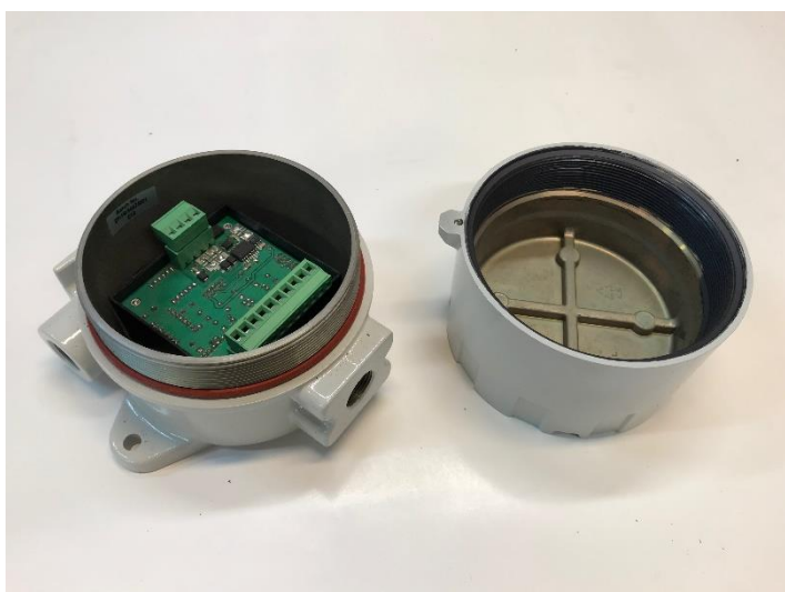
Rys. 2 Widok urządzenia przygotowanego do zalania masą żywiczną
