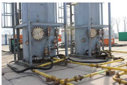
Rys. 17. Separator pionowy w analizowanej instalacji roboczej.
