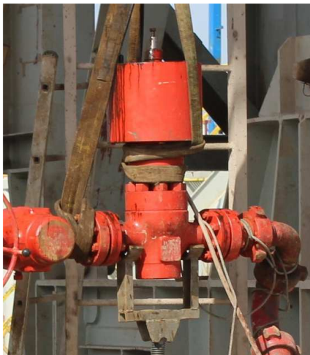
Rys.5. Zasuwa bezpieczeństwa 2 1/16" 10000 psi produkcji Cameron.
