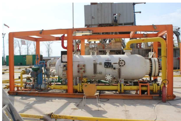
Rys. 9. Separator trójfazowy poziomy w trakcie testu.
