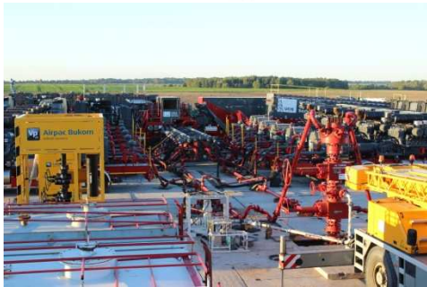
Rys. 23, 24, 25. Separatory cząstek stałych w przepływie medium (tutaj Tetra) i odpiaszczacz w trakcie testu po szczelinowaniu.
