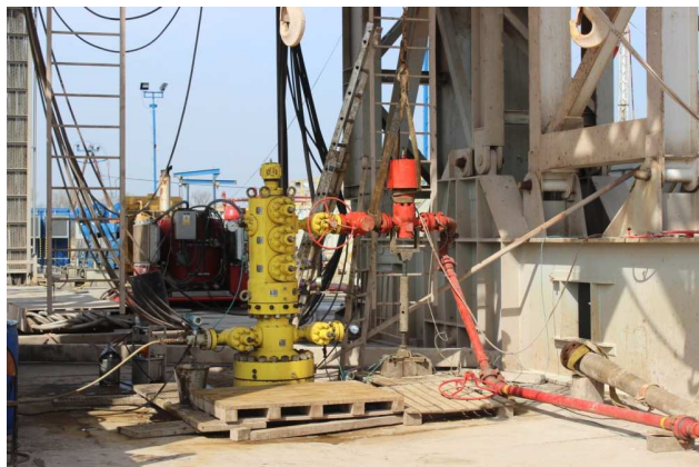
Rys.3 Widok głowicy eksploatacyjnej produkcji ZUN Naftomet typu „Solid Block” z dedykowaną zasawą bezpieczeństwa 21/16” x 70 MPa Cameron
