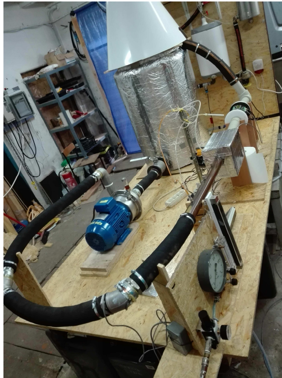
Rys. 5. Układ rurociągowy przepływu medium złożowego.
