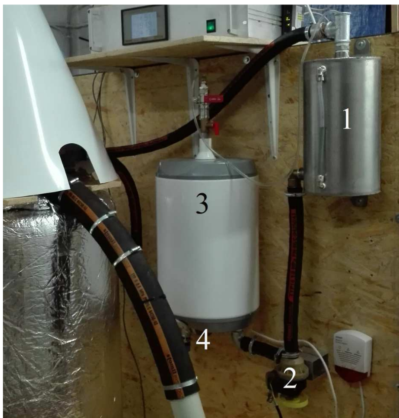
Rys. 2. Układ przygotowania temperatury medium złożowego.
