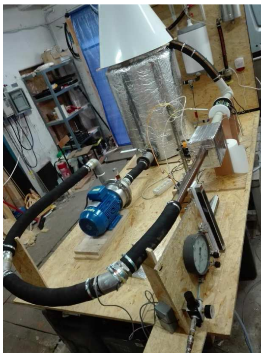
Rys. 1. Schemat systemu pomiaru zawartości fazy w przepływie płynu złożowego i widok realizacji.
