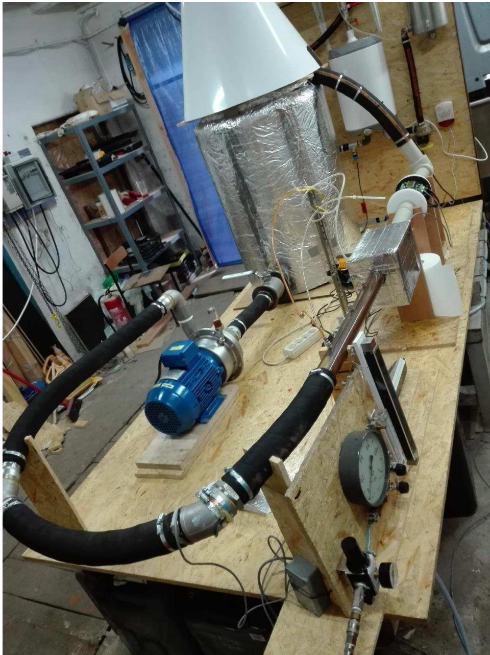
Rys. 2 Zmontowany układ pomiarowy z układem grzewczym ropy
