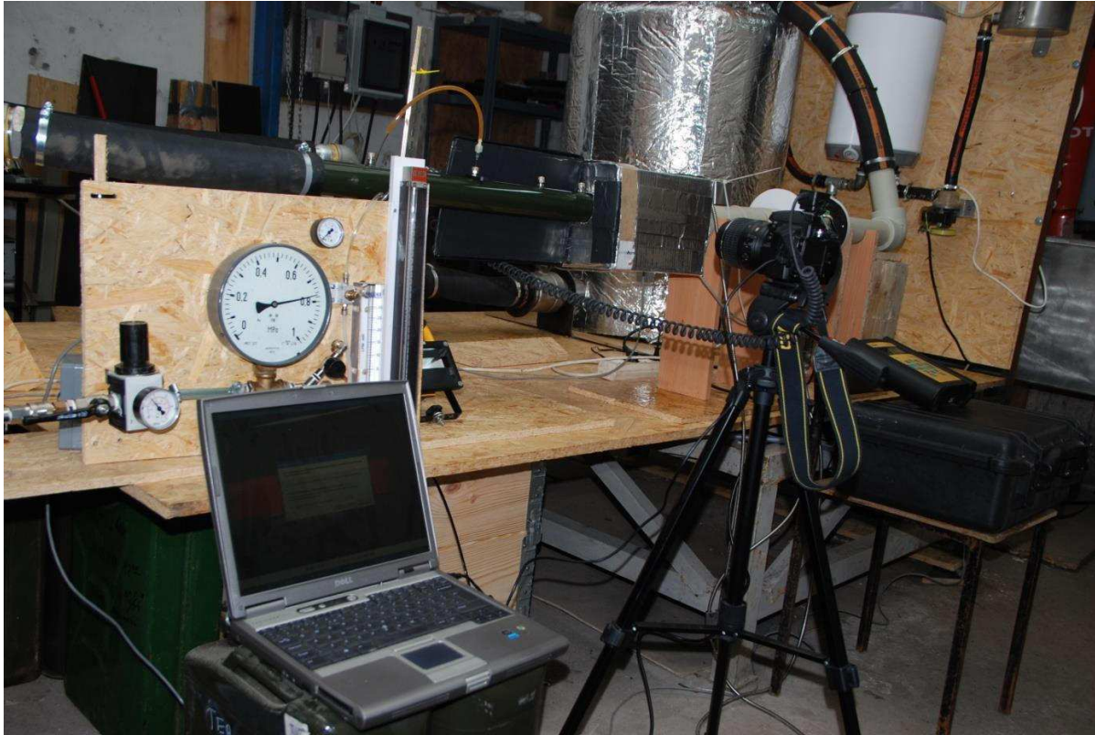
Zdjęcie 7. Zdjęcie stanowiska do robienia zdjęć przepływającego w odcinku pomiarowym.
