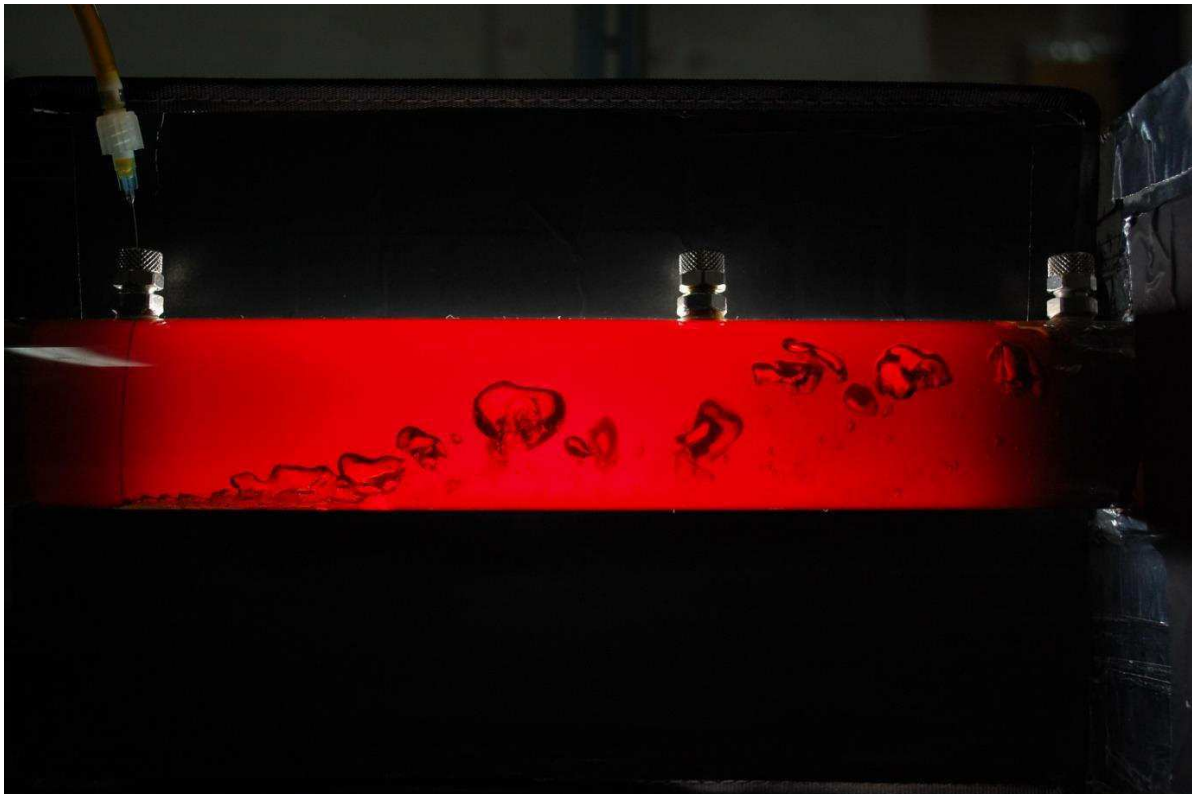
Zdjęcie 4. Przepływ medium 5,8 m 3 , ilość podawanego powietrza 1 l/min. Pojemność: 2,3889 pF.
