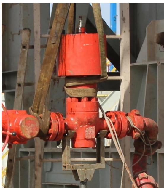
Rys.6. Zasuwa bezpieczeństwa 2 1/16" 10000 psi produkcji Cameron.
