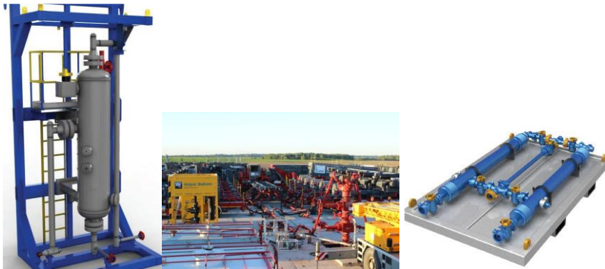
Rys. 27, 28, 29. Separatory cząstek stałych w przepływie medium (tutaj Tetra) i odpiaszczacz w trakcie testu po szczelinowaniu
