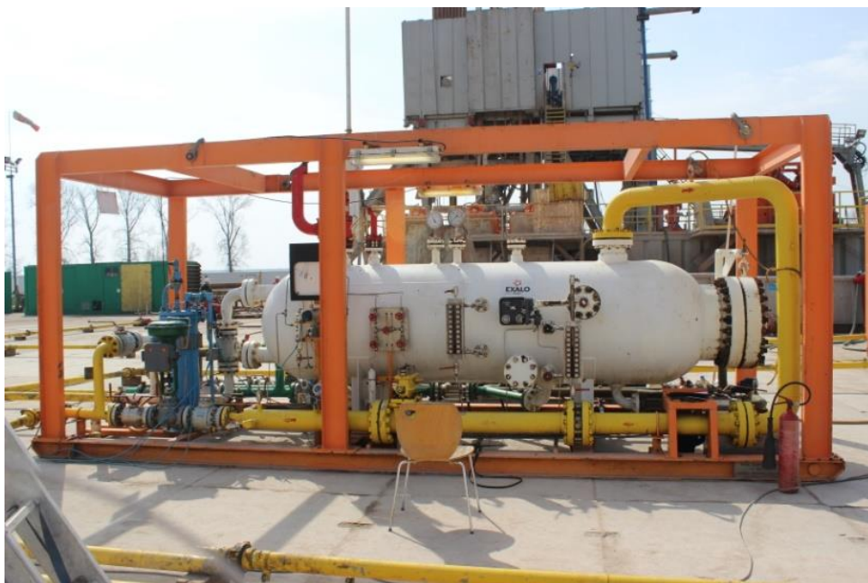
Rys. 13. Separator trójfazowy poziomy w trakcie testu.
